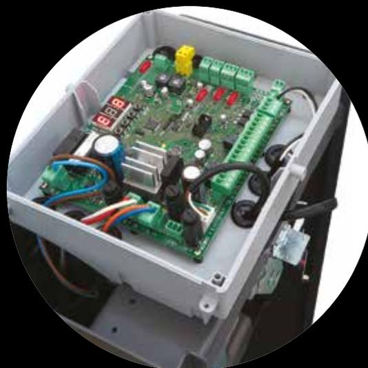
Mit der praktischen 7-Segment-Anzeige und den Bedientasten können Sie mit wenigen Schritten durch das Menü navigieren und die Schranke konfigurieren.
